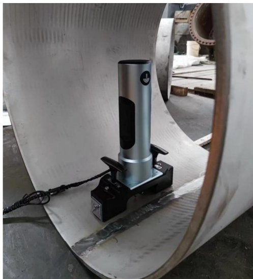
筒节纵焊缝残余应力检测
