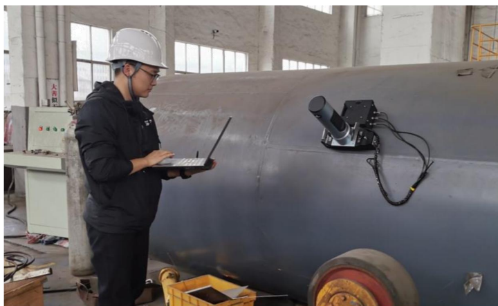
换热器出厂前焊缝残余应力检测
